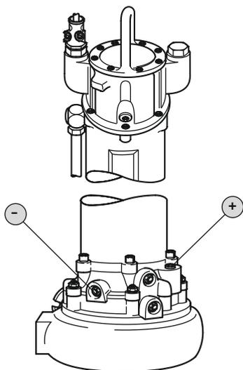
Fig. 14: Cámara de obturación: Cambio de aceite
