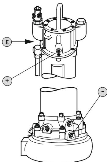
Fig. 12: Compartimento del motor: Cambio de aceite
