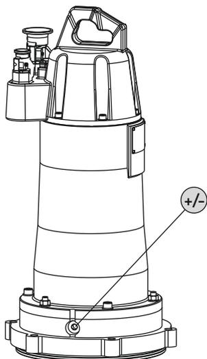
Fig. 11: Compartimento del motor: Cambio de aceite
