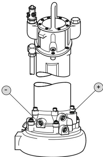
Fig. 7: Cámara de obturación: comprobar el aceite
