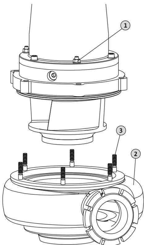
Fig. 15: Cambio de carcasa hidráulica
