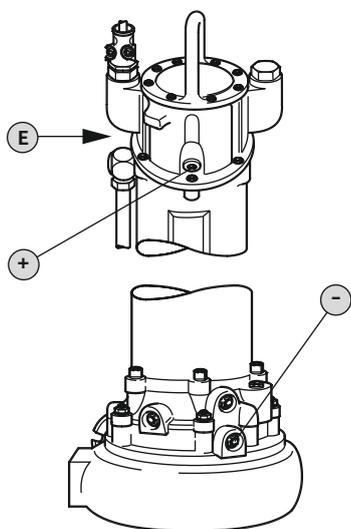
Fig. 5: Compartimento del motor: comprobar el aceite
