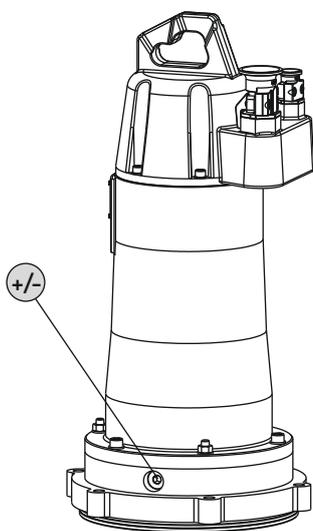
Fig. 13: Cámara de obturación: Cambio de aceite
