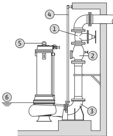
Fig. 8: Nassaufstellung, stationär
