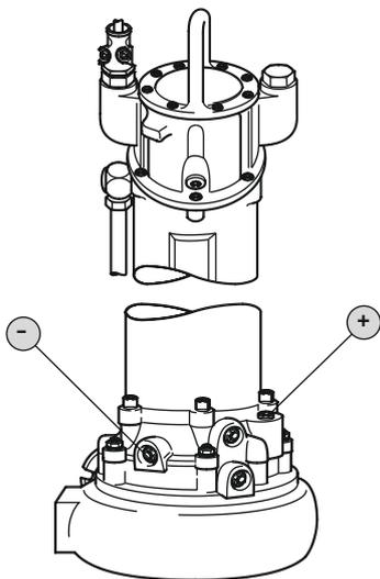
Fig. 7: Dichtungskammer: Öl prüfen
