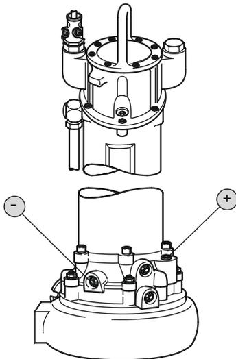
Fig. 14: Dichtungskammer: Ölwechsel
