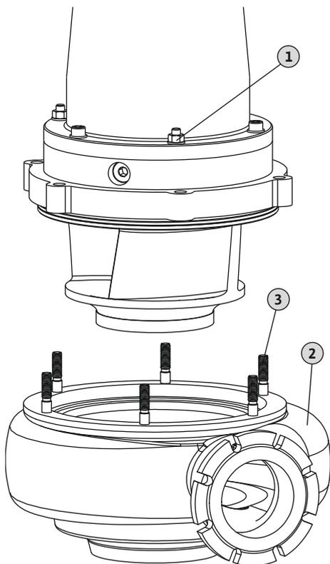
Fig. 15: Hydraulikgehäuse wechseln
