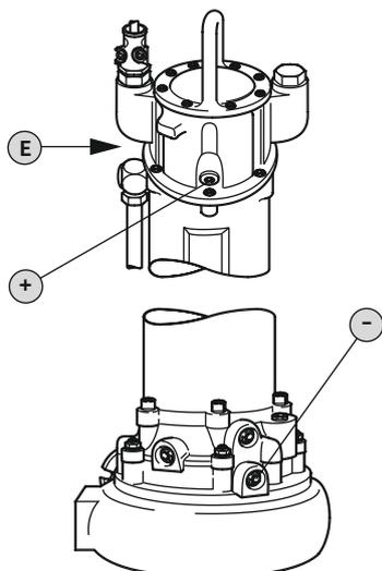
Fig. 12: Motorraum: Ölwechsel
