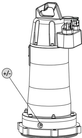
Fig. 6: Dichtungskammer: Öl prüfen
