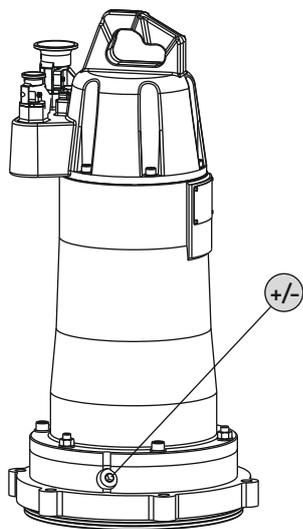
Fig. 11: Motorraum: Ölwechsel
