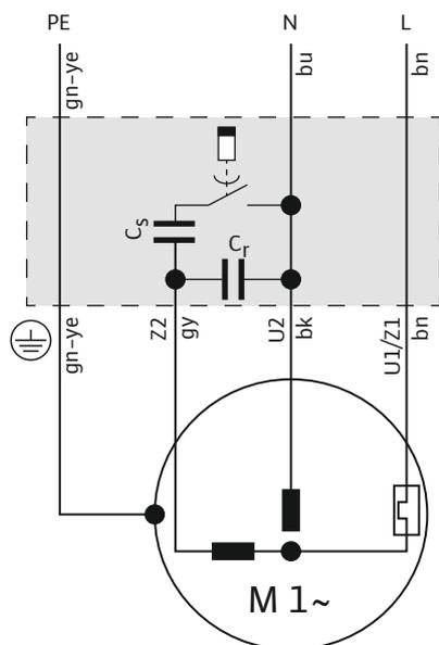
Fig. 7: Schema degli allacciamenti motore a corrente alternata
