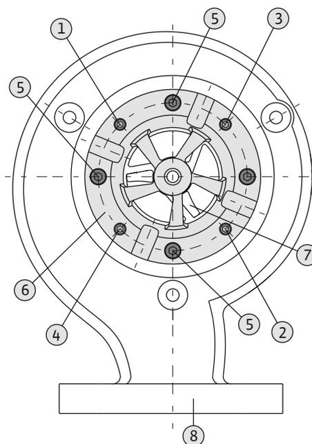
Fig. 10: Correzione della fessura di taglio
