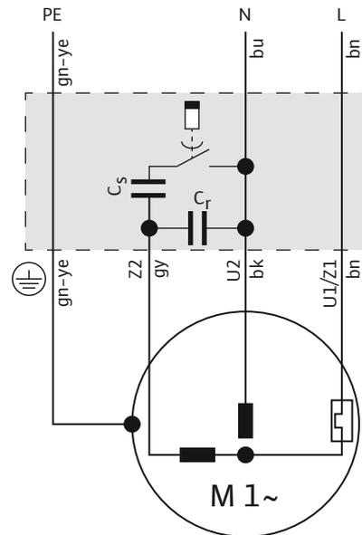
Fig. 7: Anschlussplan Wechselstrommotor
