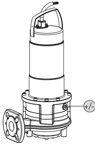
Fig. 9: Dichtungskammer: Ölwechsel
