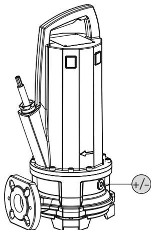
Fig. 10: Cámara de obturación: Cambio de aceite
