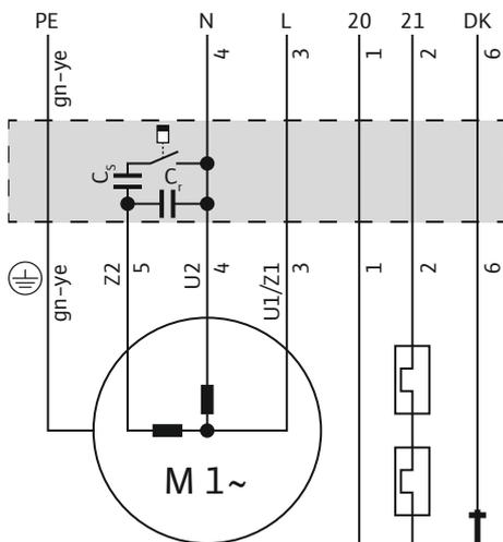
Fig. 7: Esquema de conexión del motor de corriente alterna
