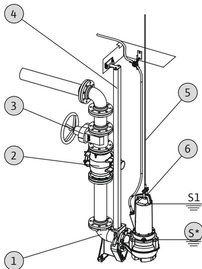
Fig. 5: Nassaufstellung, stationär
