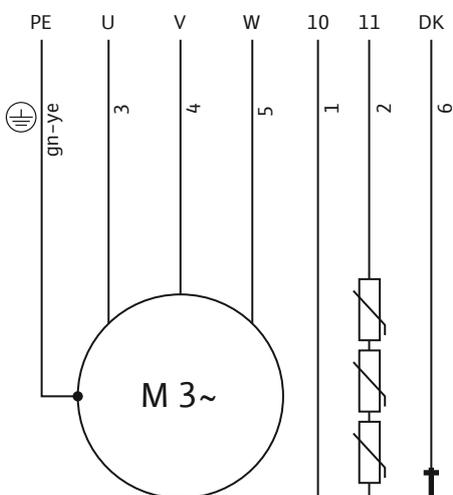
Fig. 9: Anschlussplan: Direktanlauf, PTC-Fühler
