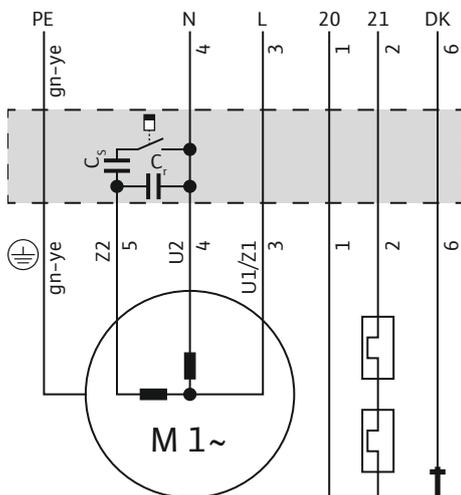
Fig. 7: Anschlussplan Wechselstrommotor
