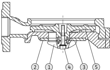
Fig. 11: Schneidspalt einstellen
