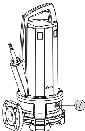
Fig. 10: Dichtungskammer: Ölwechsel
