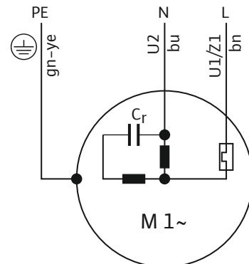
Fig. 7: Šema priključivanja za 1~ motor
