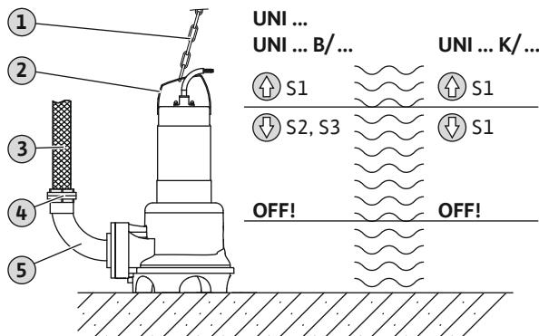
Fig. 6: Prenosna montaža u vlažnom prostoru
