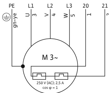
Fig. 8: Šema priključivanja za 3~ motor
