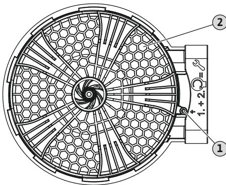
Fig. 9: Demontaža osnovne ploče
