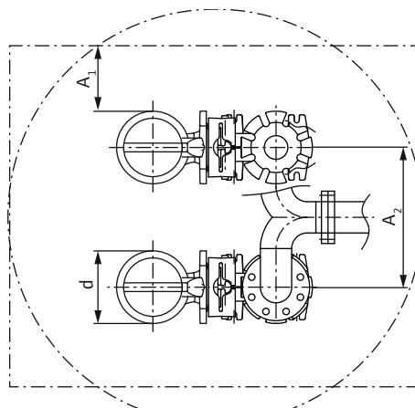
Fig. 3: Minimalna odstojanja
