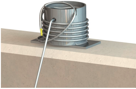
Fig. 9: Oprema za dviganje je zavarovana na privezniku
