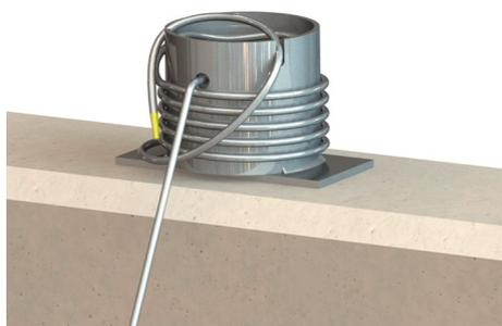
Fig. 9: Mezzo di sollevamento fissato al paletto di fissaggio
