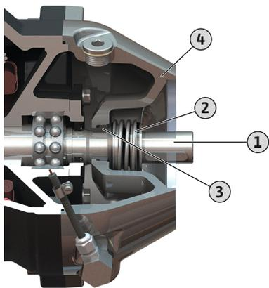
Fig. 14: Substituição do empanque mecânico
