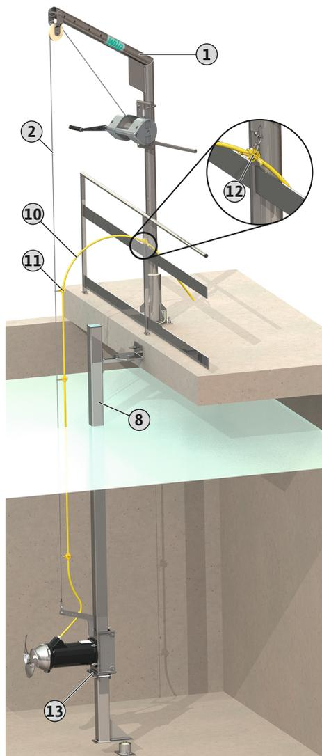
Fig. 8: Colocar o mecanismo agitador sobre o limite de parada fixado
