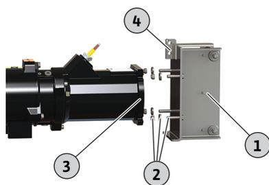
Fig. 16: Changer le châssis
