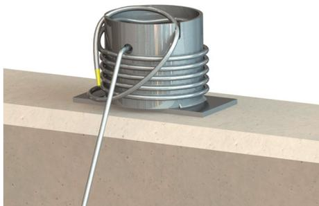
Fig. 9: Hebemittel am Seilpoller gesichert
