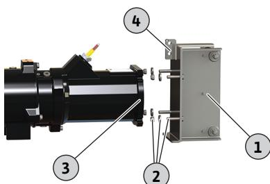
Fig. 16: Výměna rámu
