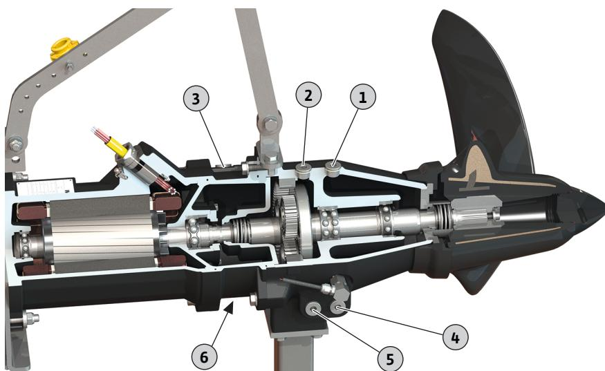
Fig. 11: Výměna oleje
