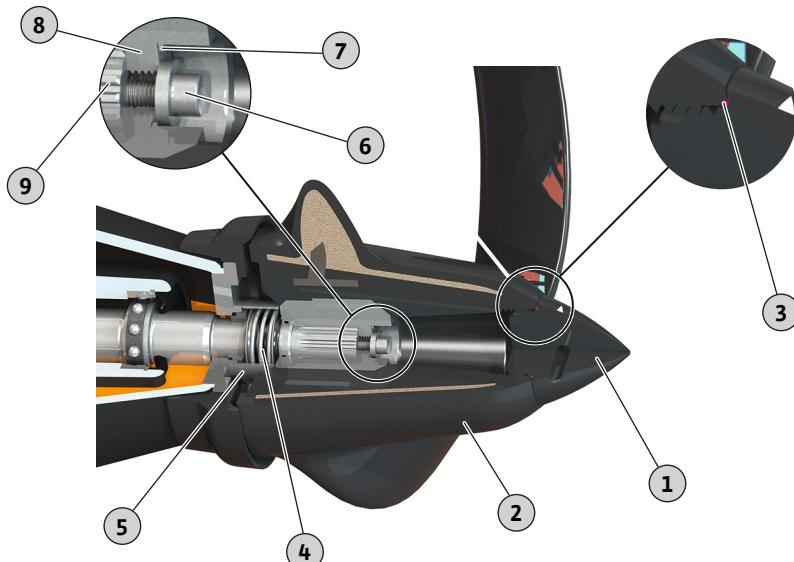
Fig. 12: Výměna vrtule (plast)
