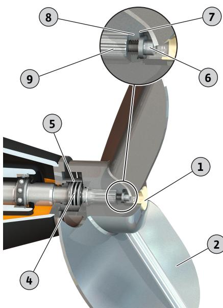
Fig. 13: Výměna vrtule (nerezová ocel)
