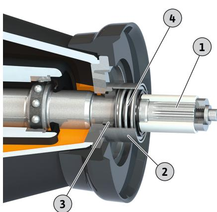
Fig. 14: Výměna mechanické ucpávky
