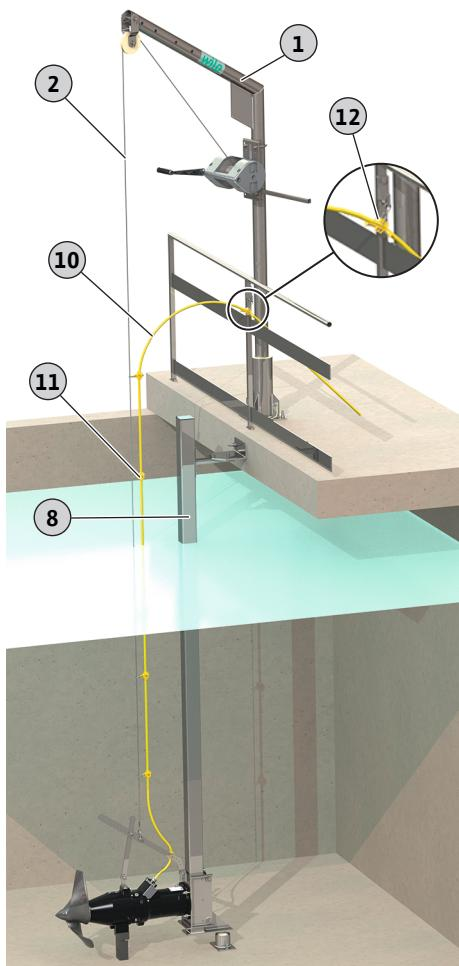
Fig. 8: Míchadlo je spuštěné až na pevný doraz
