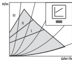
Рекомендуется для двухтрубных систем отопления с радиаторами с целью снижения уровня шума при протекании воды через термостатические вентили.
