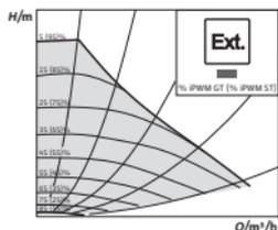
Необходимое для регулировки сравнение заданного/ фактического значений производится внешним регулятором. В качестве управляющей величины на насос подается сигнал PWM (широотно-импульсной модуляции).
