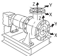
Fig. 1: Forze e coppie ammesse per le flange delle pompe – pompe in ghisa grigia
