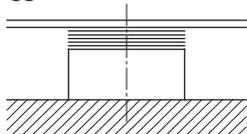
Fig. 6: Rondelle di compensazione sulla superficie del basamento
