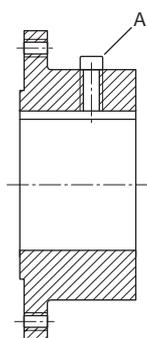
Fig. 17: Vite di regolazione A per serraggio assiale
