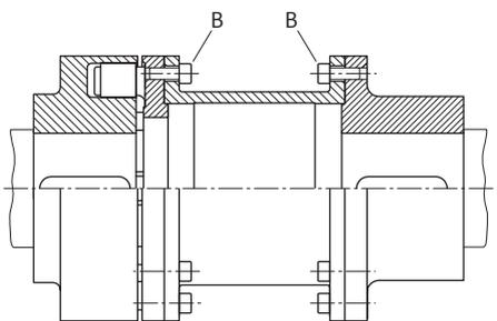
Fig. 18: Viti di fissaggio B dei semigiunti
