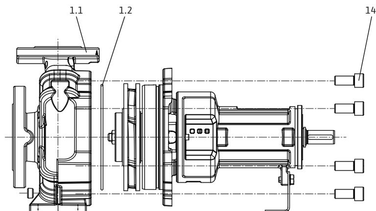
Fig. 30: Inserire l'unità ad innesto
