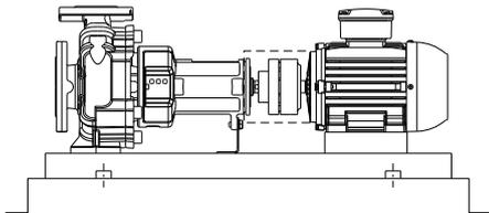
Fig. 5: Installazione del gruppo su basamento in cemento
