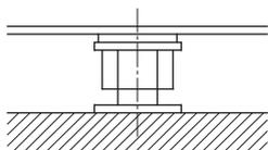
Fig. 7: Viti di livellamento sulla superficie del basamento
