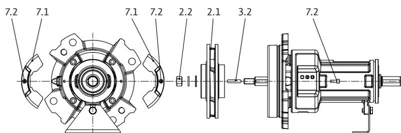
Fig. 29: Montaggio dell'unità ad innesto
