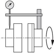
Fig. 13: Verifica dell'allineamento radiale con un comparatore
