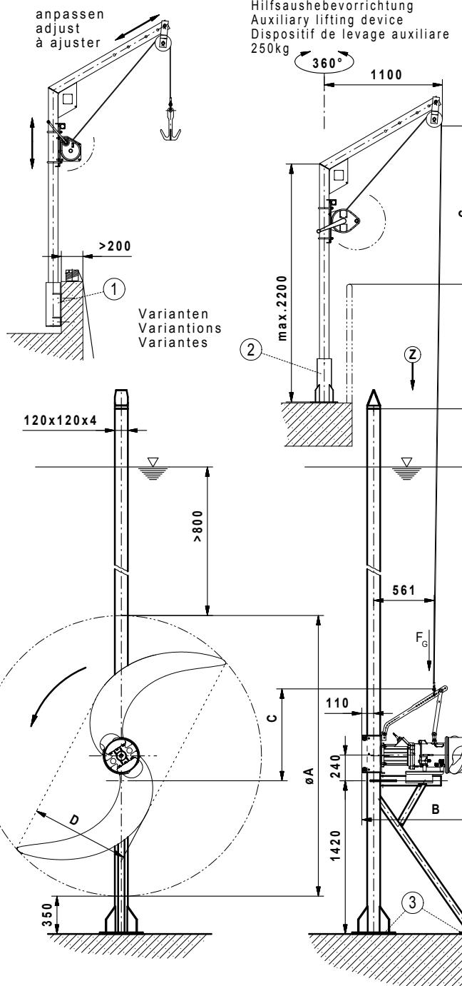
Sämtliche Anschlüsse gedübelt mittels HVA-Verbundanker
