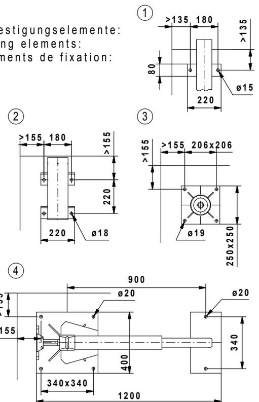
Lieferumfang: Absenkvorrichtung bis einschließlich Befestigungselemente, Rührwerk mit 10m Kabel (Überlängen auf Anfrage).
