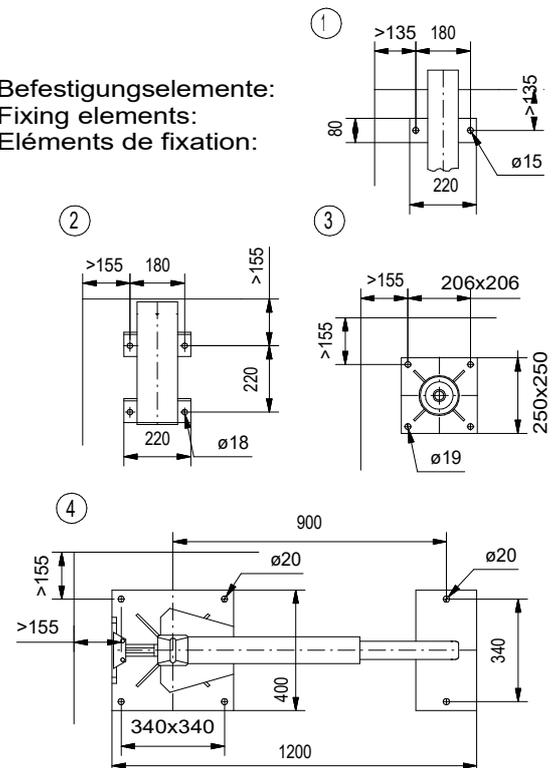
Lieferumfang: Absenkvorrichtung bis einschließlich Befestigungselemente, Rührwerk mit 10m Kabel (Überlängen auf Anfrage).
