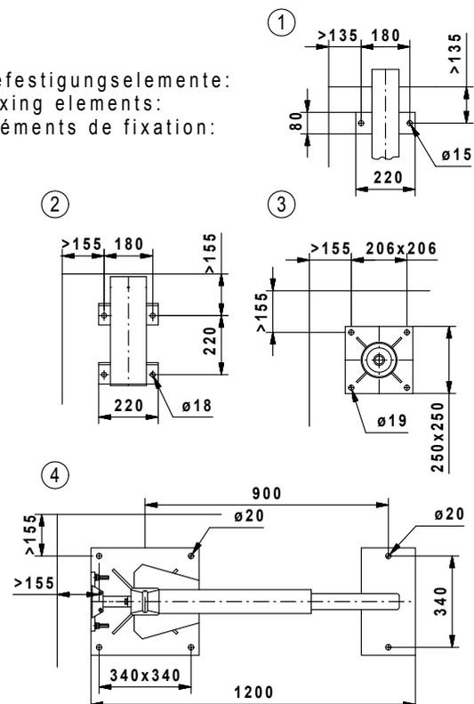
Lieferumfang: Absenkvorrichtung bis einschließlich Befestigungselemente, Rührwerk mit 10m Kabel (Überlängen auf Anfrage).
