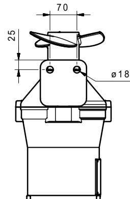
Sämtliche Anschlüsse gedübelt mittels HVA-Verbundanker M12
