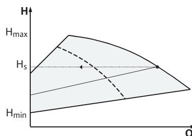
Sl. 15: Regulacija  $\Delta p - v$  (paralelni pogon)**6.3.2 Ponašanje u pogonu dvostrukih pumpa****Izmjena pumpi**
