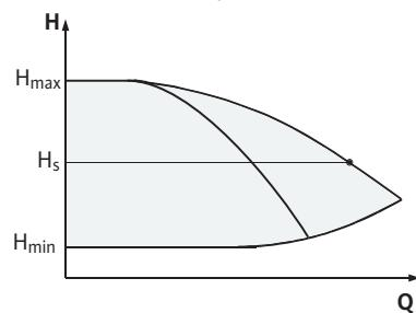
Fig. 14: Regolazione  $\Delta p - c$  (funzionamento in parallelo)
