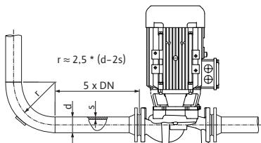
Fig. 21: tramo de estabilización delante y detrás de la bomba
