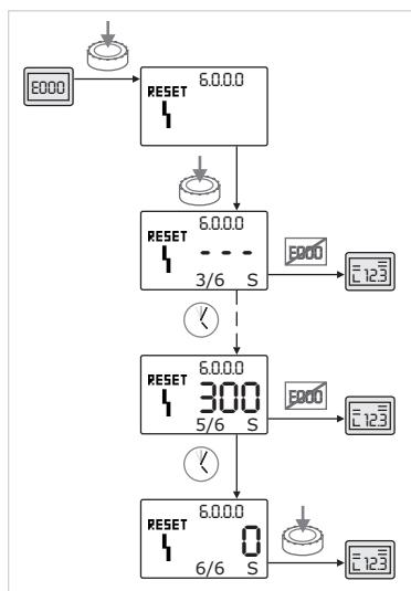
Fig. 50: confirmación del tipo de fallo C
