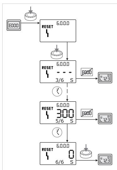
Fig. 50: Kvittering af fejltyp C
