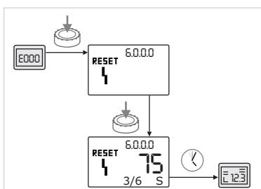
Fig. 47: confirmación del tipo de fallo B (X &lt; Y)
