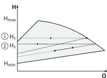
Fig. 40: Regulação  $\Delta p-c/\Delta p-v$
