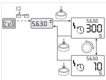
Fig. 35: Indstilling med tilbagevenden til menuelementet "valg/indstillinger"
