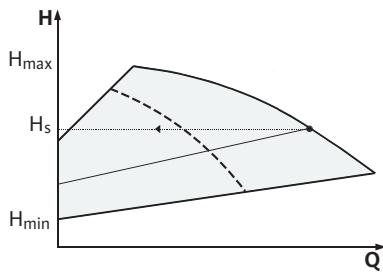
Fig. 15: Regolazione  $\Delta p$ -v (funzionamento in parallelo)
