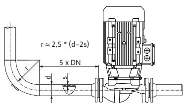
Fig. 21: Stille strækning før og efter pumpen
