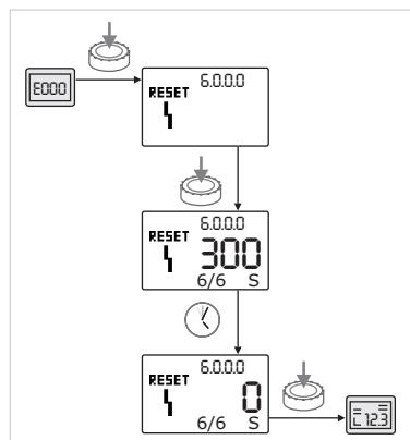
Fig. 48: Kvittering af fejtype B (X=Y)
