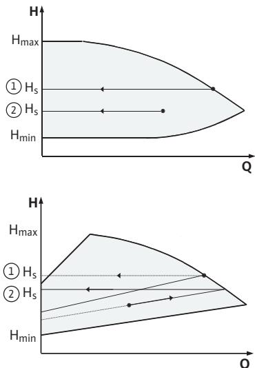
Fig. 40: Regolazione  $\Delta p_c/\Delta p_v$
