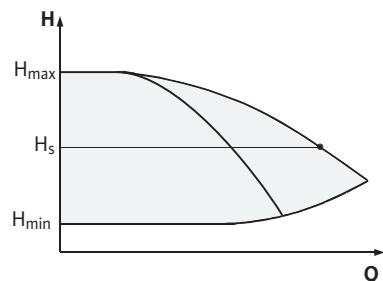
Fig. 14: Regulación  $\Delta p$ -c (funcionamiento en paralelo)
