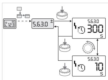
Fig. 35: Regulação com retorno ao elemento de menu “Seleção/regulações”
