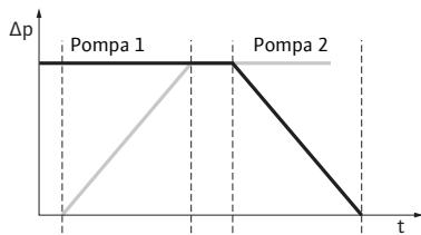
Fig. 16: Scambio pompa
