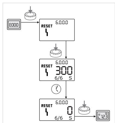
Fig. 48: confirmación del tipo de fallo B
