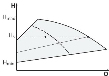
Fig. 15: regulación  $\Delta p$ -v (funcionamiento en paralelo)
