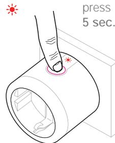
Die Sensortaste 5 Sekunden drücken bis die LED rot blinkt.
