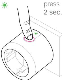
Die Sensortaste kurz los lassen und erneut für 2 Sekunden drücken bis die LED grün blinkt, um das Löschen zu bestätigen. → WEITER drücken
