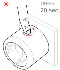
Die Sensortaste 20 Sekunden gedrückt halten bis die LED durchgehend rot leuchtet. Alle zuvor angelernten Geräte werden gelöscht. → WEITER drücken
