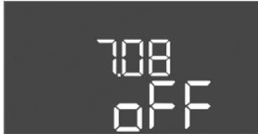
Fig. 74: Ponastavitev intervala vzdrževanja
