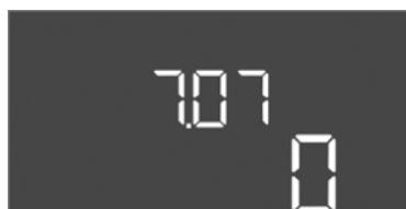
Fig. 73: Zapnutí intervalu údržby
