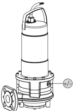
Fig. 9: Cámara de obturación: Cambio de aceite
