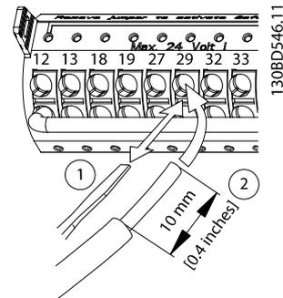
Illustration 4.26 Raccordement du câblage de commande
