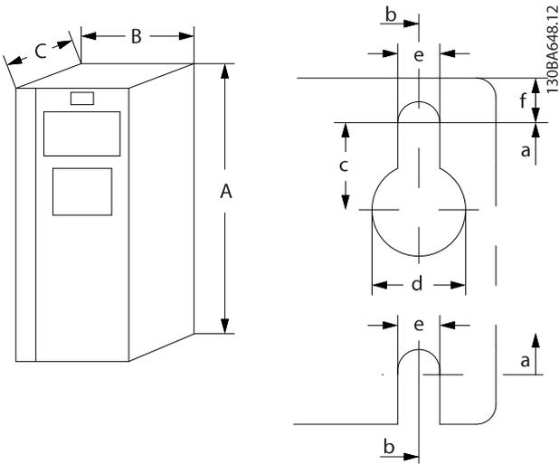
Ilustración 3.4 Agujeros de montaje superiores e inferiores
