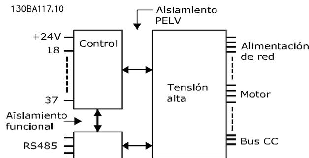
Ilustración 8.1 Aislamiento PELV de entradas analógicas
