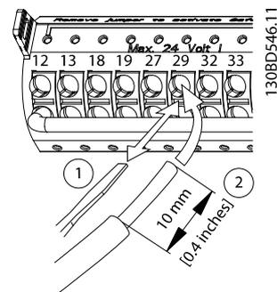
Ilustración 4.10 Conexión de los cables de control
