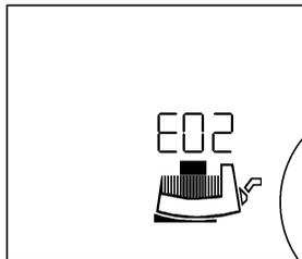
Üzemzavar esetén az aktuális üzemzavar az **E = Error**, a **kódszám** és a hibaforrás (motor, szabályozó modul vagy hálózati csatlakozás) villogása révén jelenik meg.
