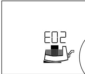
Arıza durumunda güncel arıza **E = Error**, **kod no.** ve hata kaynağı, motor, regülasyon modülü veya elektrik şebekesi bağlantısı göstergesinin yanıp sönmeyeyle gösterilir.
