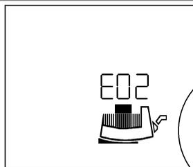
V primeru motnje je aktualna motnja prikazana z **E** = Error, s **št. kode** in z utripanjem izvora motnje (motor, regulacijski modul ali omrežni priključek).
