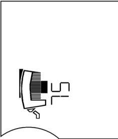
Bu yolla: sol pompa Master (ana pompa), sağ pompa ise Slave (yedek pompa) olarak seçilmiş olur. Yedek pompa üzerinde bulunan çevirmeli düğme artık kullanılmaz.
