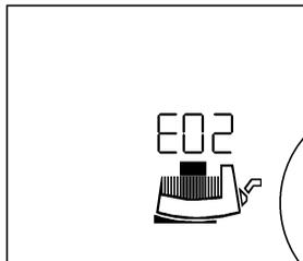
В случай на повреда актуалната грешка се сигнализира посредством символа **E = Error**, **номера на кода** и чрез мигане на източника на грешката – мотор, регулиращ модул или ел. захранване.
