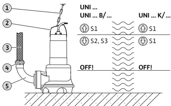
Fig. 6: Montaggio sommerso mobile
