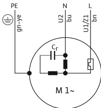
Fig. 7: Schema degli allacciamenti motore 1~
