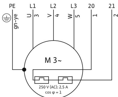
Fig. 8: Schema degli allacciamenti motore 3~
