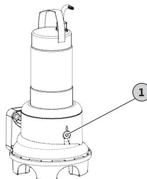
Fig. 10: Camera di tenuta: Cambio d'olio
