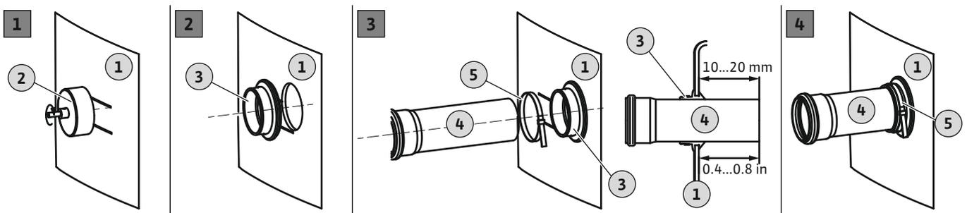
Fig. 5: Zulauf anschließen
