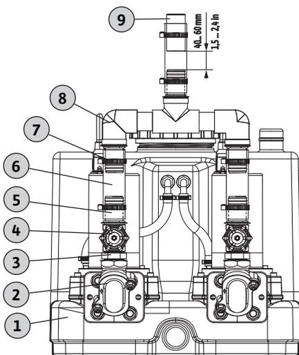
Fig. 3: Druckanschluss anbringen
