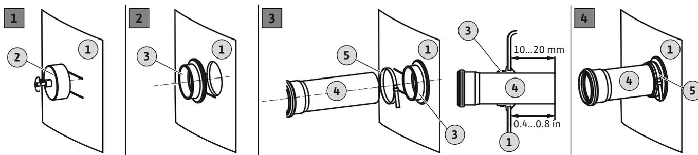
Fig. 5: Raccordement de l'aspiration
