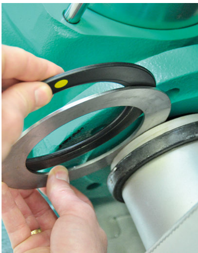
Anordnung Gummiflanschdichtung und Beilagscheibe.
