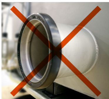
ACHTUNG! Falsch montierte Dichtung.
