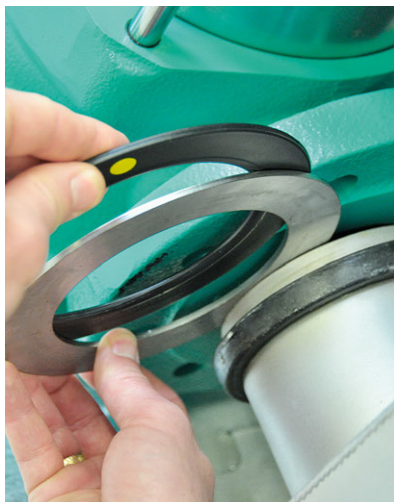
Anordnung Gummiflanschdichtung und Beilagscheibe.
