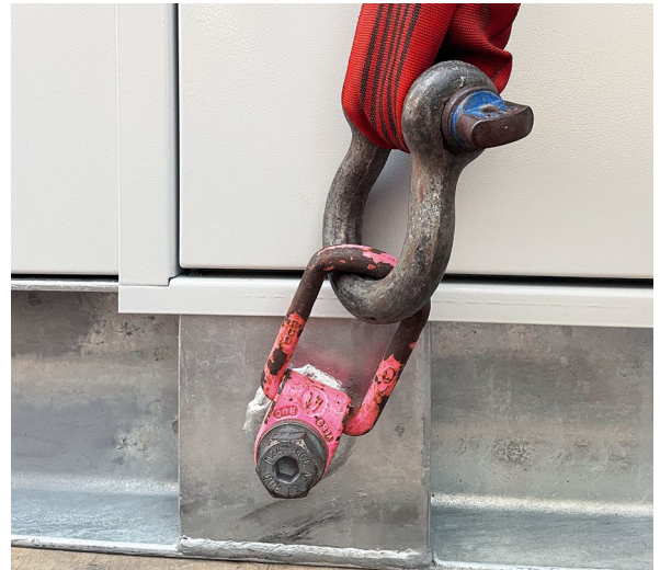
Befestigte Transportösen am Anschlagpunkt mit Gewinde M24.
