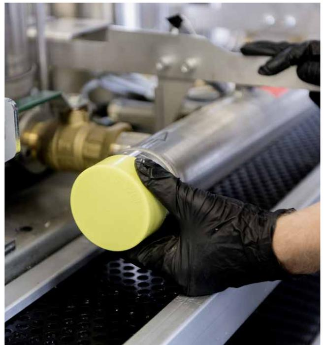
Nach der thermischen Desinfektion werden die Druckerhöhungsanlagen mit verschlossenen Rohrenden sowie in einer Schutzverpackung ausgeliefert
