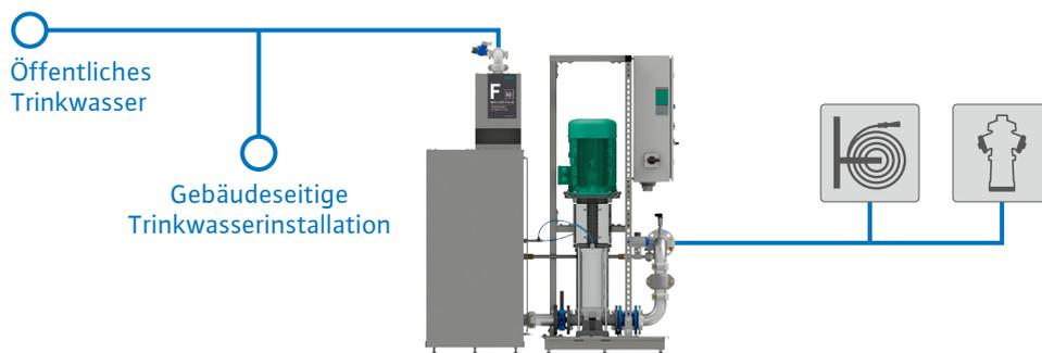
Mittelbarer Anschluss einer Löschwasseranlage an das Trinkwassernetz, ohne hygienische Risiken.
