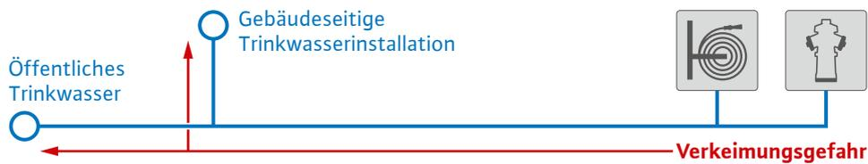
Unmittelbarer Anschluss einer Löschwasseranlage an das Trinkwassernetz, verbunden mit hygienischen Risiken (Verkeimungsgefahr).
