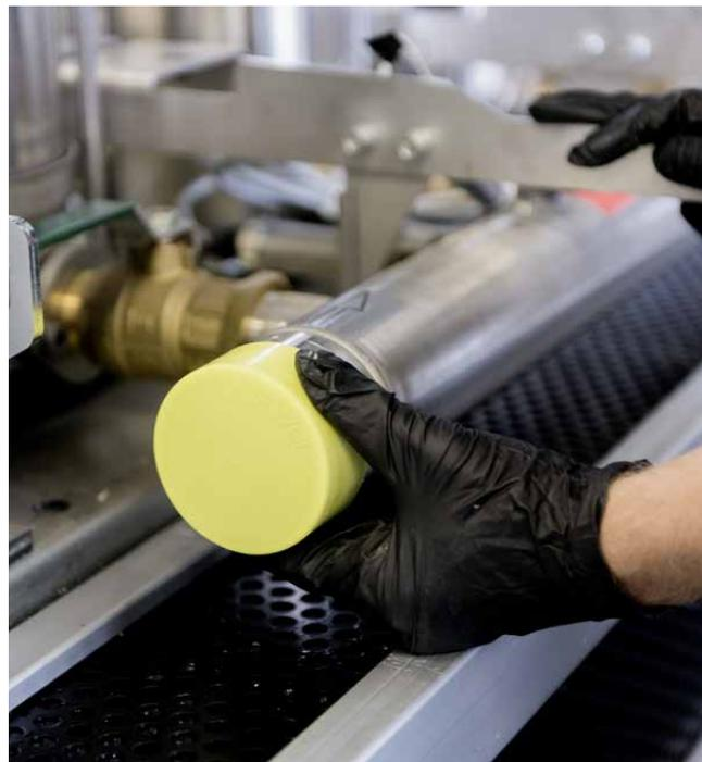
Nach der thermischen Desinfektion werden die Druckerhöhungsanlagen mit verschlossenen Rohrenden sowie in einer Schutzverpackung ausgeliefert
