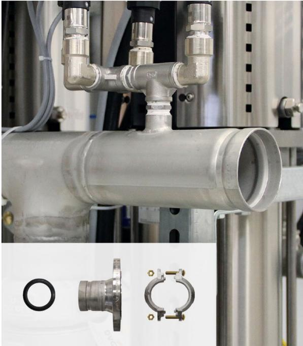
1. Flansch und Kupplung liegen der Trennstation bei.
