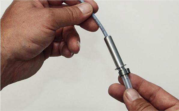
5. Die Schlauchschelle wird bündig auf die Schlauchtülle geschoben.
