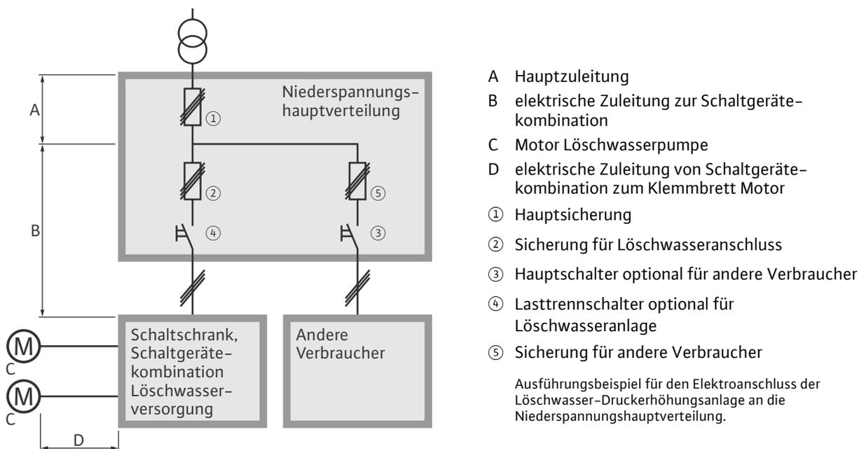
Die Dimensionierung der elektrischen Zuleitung zur Schaltgerätekombination (B), hat nach dem Bemessungsstrom zu erfolgen. Dieser wird für sicherheitsrelevante Anlagen, abweichend von der üblichen häuslichen Installation, auf den 1,5-fachen Nennstrom ausgelegt (siehe Bemessungsstrom).
