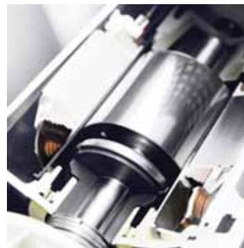
Canotto separatore in materiale sintetico che previene le perdite per correnti parassite.
