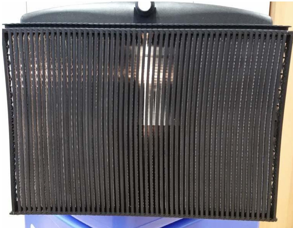
Рисунок 18: мембранний модуль – погляд крізь щілини між пластинами
