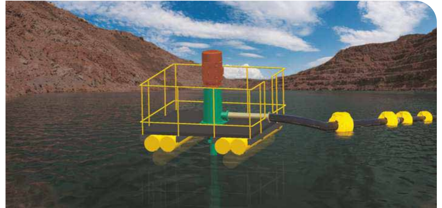
Pantoon uygulamasında dik milli türbin pompaları
