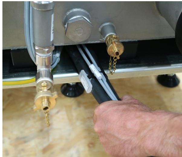
Kabelstrang mittig unter Behälter führen.
