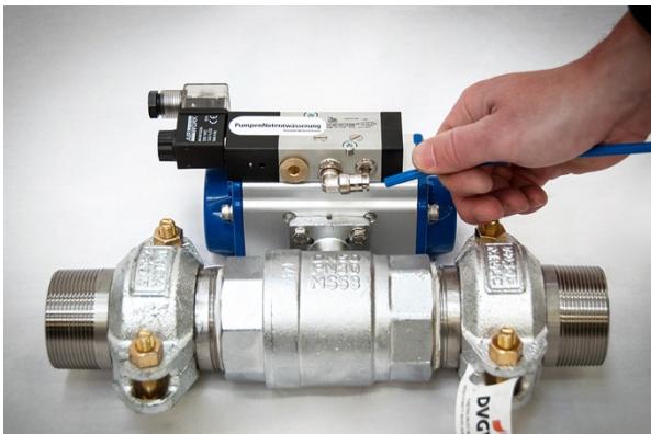
1. Der mitgelieferte Drucklufterzeuger wird mittels Steckverbindung mit der Trennstation verbunden.
