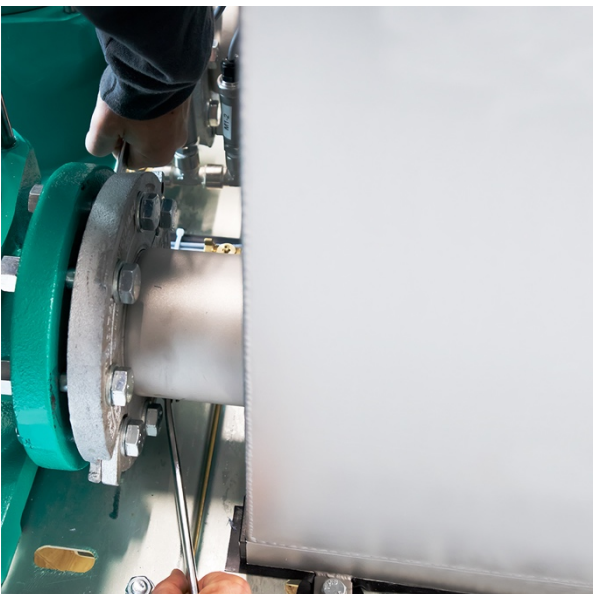
Montage unterhalb des Flansches mit Ratsche.
