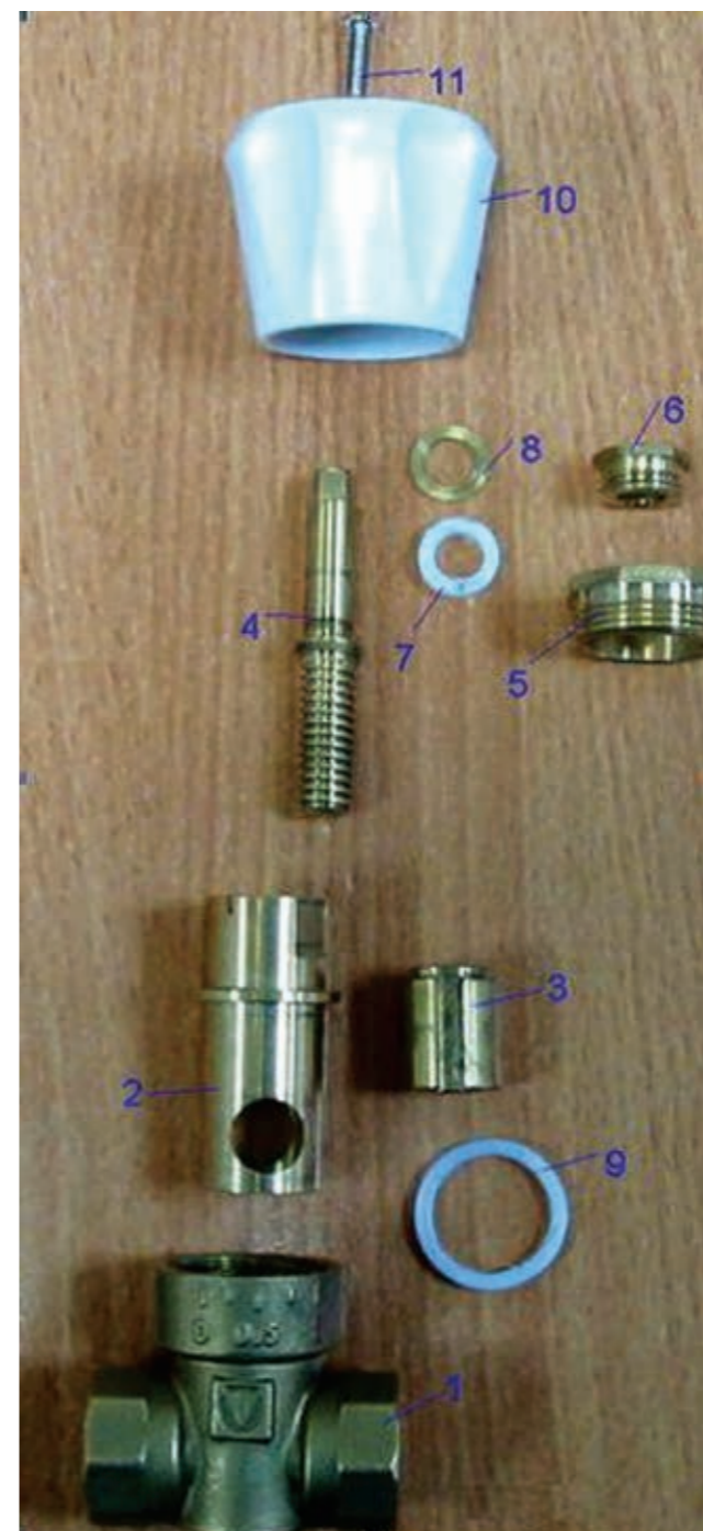
Рис. 11. Конструкция крана VT.004
