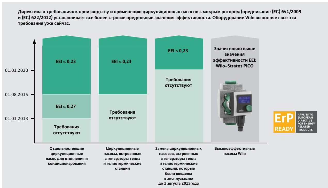
EEI = индекс энергоэффективности (определяется путем сравнения различных значений потребления мощности в рамках профиля нагрузки на примере среднестатистического насоса-образца)
