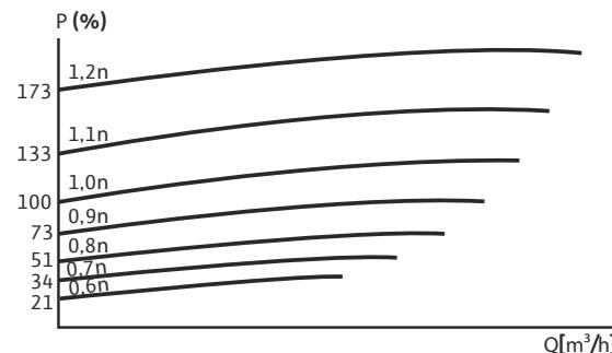
Рабочие характеристики насоса, работающего с разной частотой вращения
