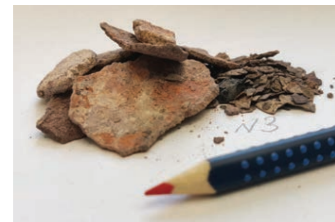
Рис. 4. Накипь из парового котла
