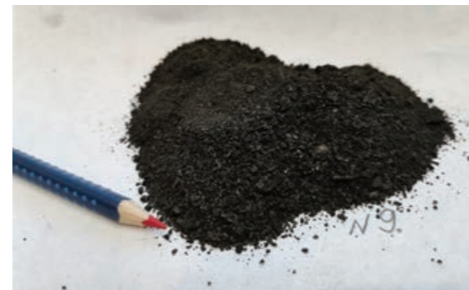
Рис. 3. Накипь из водогрейного котла
