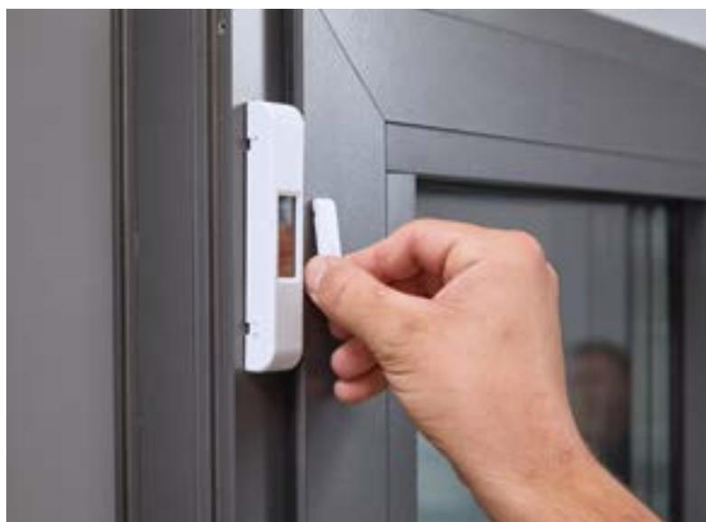
◀ Bild 6 • Fensterkontakte werden an dem auf der Rückseite der Wilo-Brain Box angebrachten Fenster installiert.
