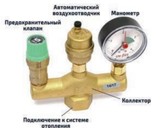
На фото показан состав классической группы безопасности: она состоит из трех элементов, соединенных коллектором (техническим элементом, разбивающим поток на несколько параллельных веток).
