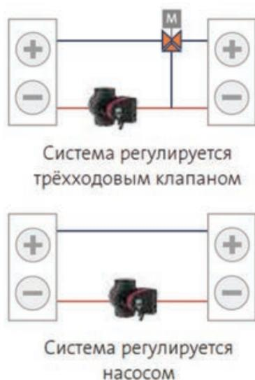
Рис. 3. Регулировка системы
