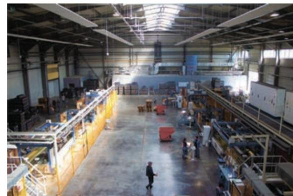
Завод Kermi в Ступино – это предприятие полного цикла с высокой степенью локализации производства. Цикл производства включает в себя процессы штамповки-сварки, многоступенчатую процедуру подготовки поверхностей радиатора к окраске (в том числе с помощью уникальной для России технологии грунтования методом катафореза – KTL), непосредственно окраску и упаковку радиаторов.
