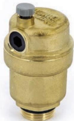
Автоматический воздухоотводчик не требует настройки или вмешательства человека. Как только в системе образуется воздух, он попадает в канал воздухоотводчика. Находящийся в этом цилиндрическом канале поплавок опускается, опуская запирающий шток: клапан открывается и стравливает из канала весь воздух.
