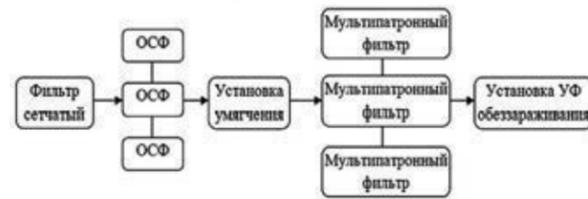
Рис. 4. Описание технологической схемы
