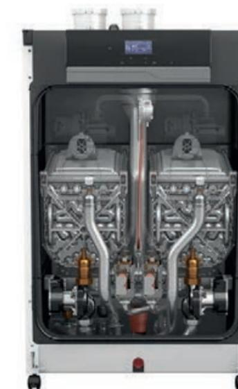
Большое внимание при разработке L PLUS уделялось удобству обслуживания. Так, для крепления горелки применяются прижимные планки, которые просто нужно повернуть шестигранным ключом. Фиксация патрубков осуществляется через быстроразъемные соединения. Все обслуживание производится с фронта котла, что не только удобно, но и позволяет монтировать котлы на минимальном расстоянии от стен и вплотную друг к другу.
