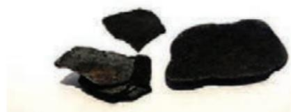
Рис. 2. Образцы накипи из котла LNE Compact 12.0
