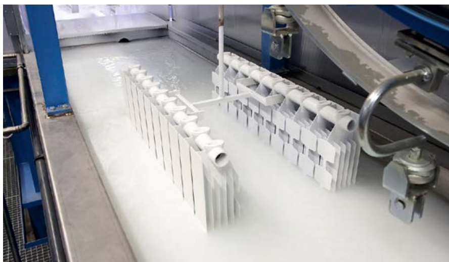
:: Линия окраски радиаторов в производственном комплексе Fondital в Липецкой области
