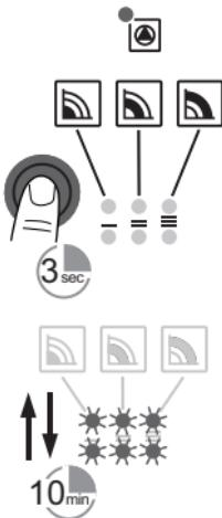
Hvis pumpen ikke luftes automatisk:
